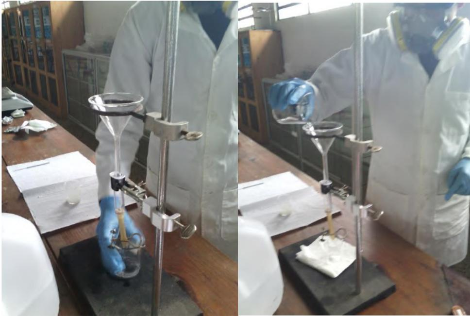
1 Preparación de columnas cromatográficas
